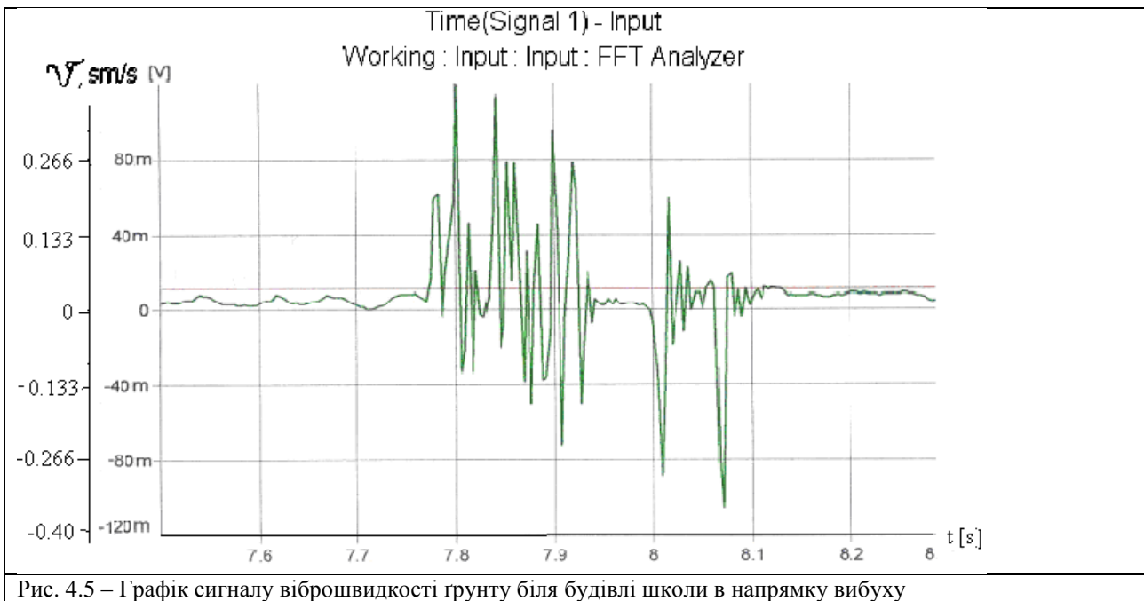
Рис. 4.5 – Графік сигналу віброшвидкості ґрунту біля будівлі школи в напрямку вибуху
