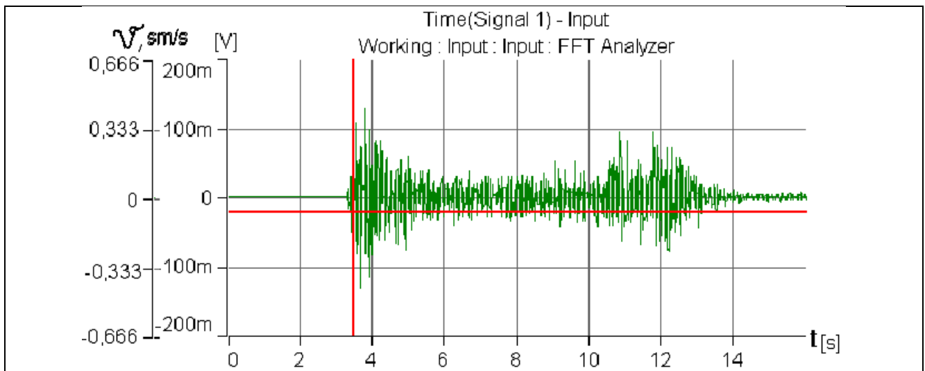
Рисунок 4.17 – Графік сигналу горизонтальної віброшвидкості ґрунту біля будівлі Центру творчості в напрямку вибуху
