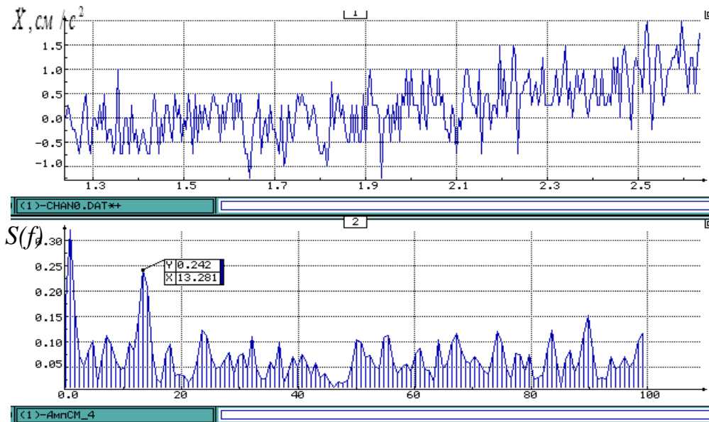
Рис. 3.9 - Вібрація і амплітудний спектр горизонтальних (уздовж осі X) віброприскорень стіни в рівні 3-го поверху будівлі по вул. Бірюзова, 7 при впливі фонові вібрації
