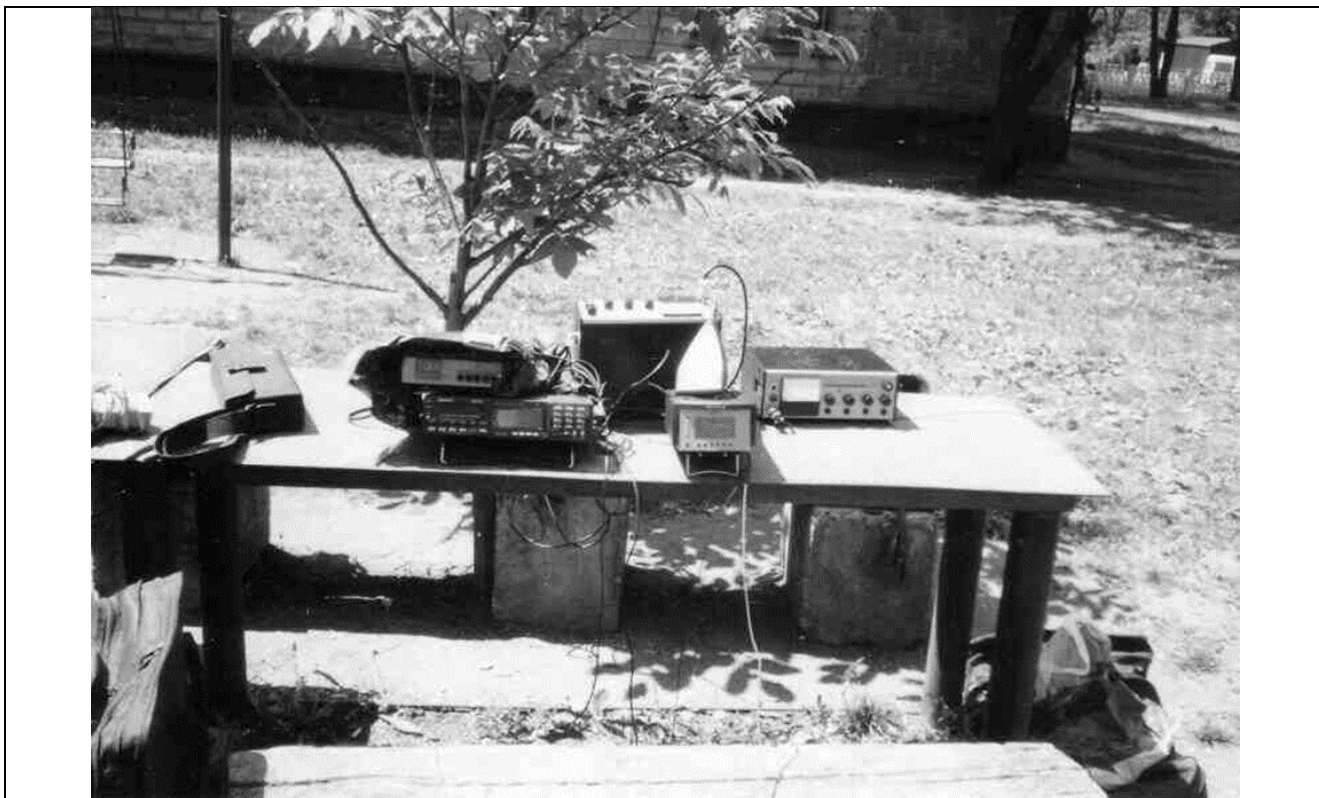
Рис. 3.7 – Віброметрична апаратура, що використовується для реєстрації та запису вібросигналів
