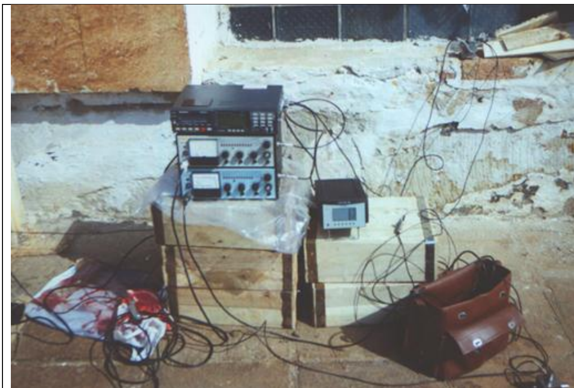
Рис. 3.35 – Віброметрична апаратура, що використовується для реєстрації та запису вібросигналів
