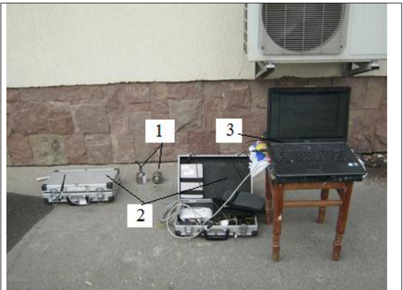
Рис. 2.3 – Загальний вигляд багатоканальної системи «Сейсмомоніторинг». Позначення: 1 – однокомпонентні датчики віброприскорень (акселерометри) моделі 731А, 2 – модуль вимірювання низькочастотної вібрації (МВНВ), 3 - ноутбук
